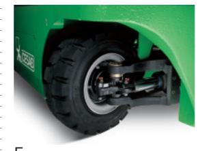
El eje trasero, de nueva concepción, permite alcanzar elevados ángulos de viraje. Está montado sobre silent blocks a fin de obtener mayor ergonomía de conducción y silenciosidad.
