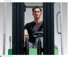
La gama cenTAURO se halla disponible con mástiles dobles y triples de nueva concepción. Los mástiles de alta visibilidad ofrecen una óptima visibilidad gracias al posicionamiento de los cilindros de elevación, alineados con los propios
