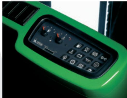
La consola de instrumentación contiene los pilotos y los códigos de error, para una fácil identificación de los mismos.
