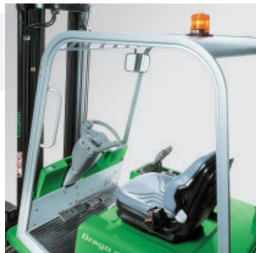
El puesto del conductor se caracteriza por su amplitud, visibilidad y adaptación en el estilo personal de manejo. La nueva columna de la dirección, que se encuentra inclinada hacia el operador y es fácilmente regulable, aumenta el confort de conducción.
