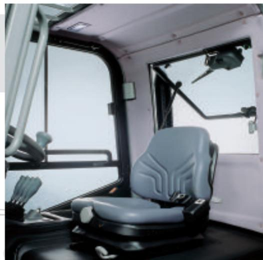
La nueva cabina completa, disponible como opción se monta en el interior del perfil de las barras de protección. En su configuración estándar está equipada con revestimientos, accesorios y cuidadas insonorizaciones, techo en lexan con canalones, cristal corredizo y limpiaparabrisas de pantógrafo.
