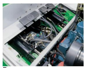
LI alojamiento de la dirección asistida hidráulica, debajo de la plataforma, permite obtener una simplificación de las conexiones y reducir los ruidos de marcha. Los pedales están montados en el panel del tablero de mandos para facilitar las tareas de regulación y mantenimiento.
