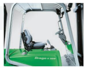
Ergonomía de los mandos. Las palancas hidráulicas, el conmutador rotativo del freno de estacionamiento, y el botón de emergencia, se encuentran al alcance de la mano y son fácilmente accesibles para el conductor. La nueva columna de la dirección, que se encuentra inclinada hacia el operador es fácilmente regulable y aumenta el confort de conducción.
