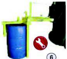
Ref. 3058 Para bidones de 200 lts de chapa Dimensiones (L x A x H) 1.700 x 1.025 x 700 mm Carga 400 kg • Peso 75 kg • Radio de giro 90°
