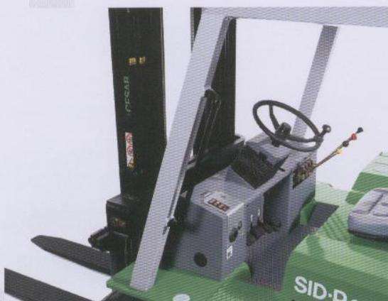
El mástil robusto y la posibilidad de montar ruedas gemelas en el eje delantero (de serie en las versiones con capacidad de 7000 y 8000 kg) permiten mover cargas anchas y descentradas en condiciones de elevada estabilidad.
