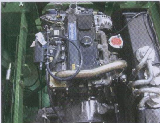
El motor, Diesel turbocomprimido con refrigeración por agua, asegura elevadas prestaciones y bajos consumos.
